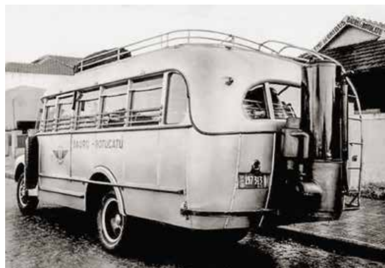
O transporte não pode parar: Durante a Segunda Guerra, o gasogênio foi a solução.
